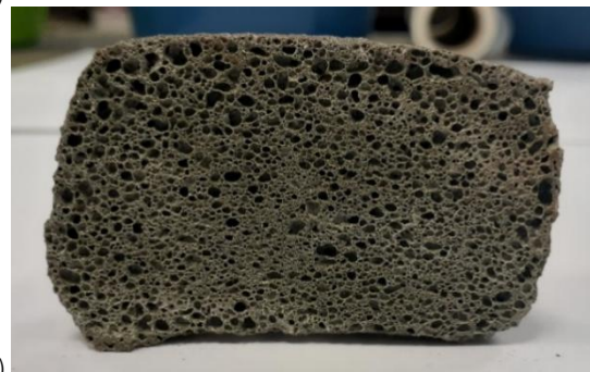
Рисунок 2 – Образцы пеностекла: а – подготовленные к тепловой обработке; б – после тепловой обработки
