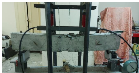
Рисунок 5. Внешний вид контрольных образцов серии БК после разрушения
