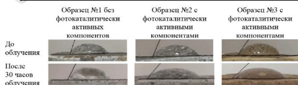
Рис. 3 – Внешний вид образцов при испытании по методу изменения контактного угла капли воды
