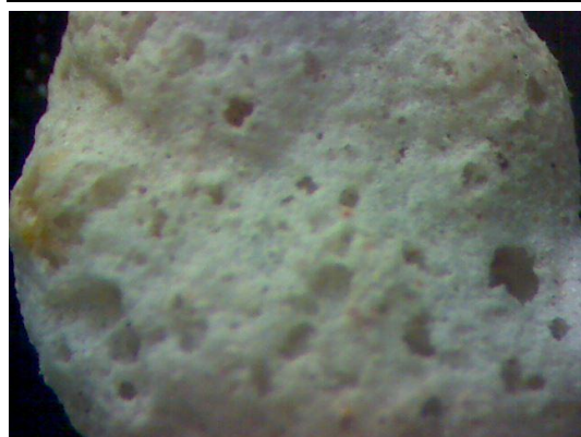
Рис. 1 – а) внешний вид заполнителя; б) поверхность заполнителя, \times 10
