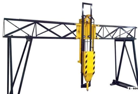
Рис. 4. Мостовая копровая установка (а) и 3D-принтер строительный (б):
